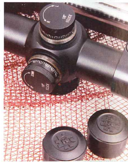
Le torrette di regolazione sono del tipo da competizione e hanno arresti ogni ottavo di moa . Sono protette da cappucci a vite.
